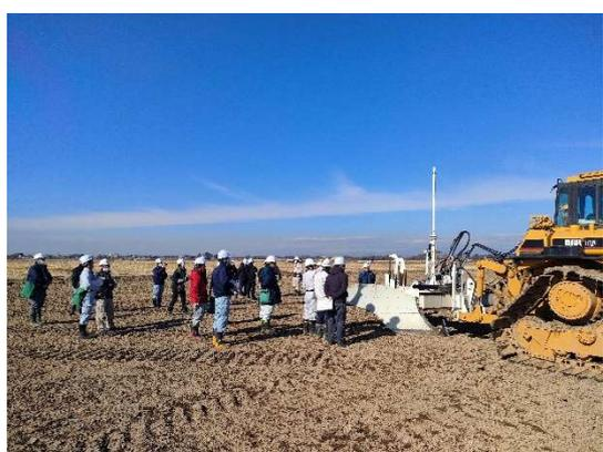
大型2段耕と運土用ブルドーザ
