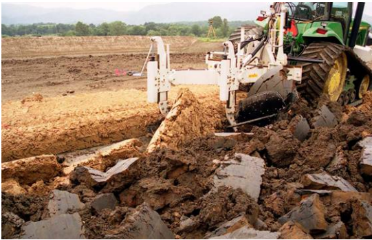
写真-15 2段耕プラウによる性能試験
