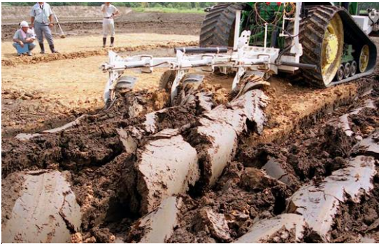
写真-14 1段耕プラウによる性能試験
